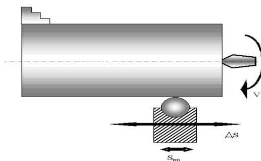
Рисунок 8 – Схема вибронакатывания шариком
