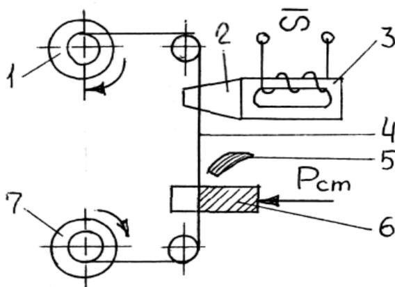
Рисунок 23 – Принципиальная схема резки непрофилированным инструментом
