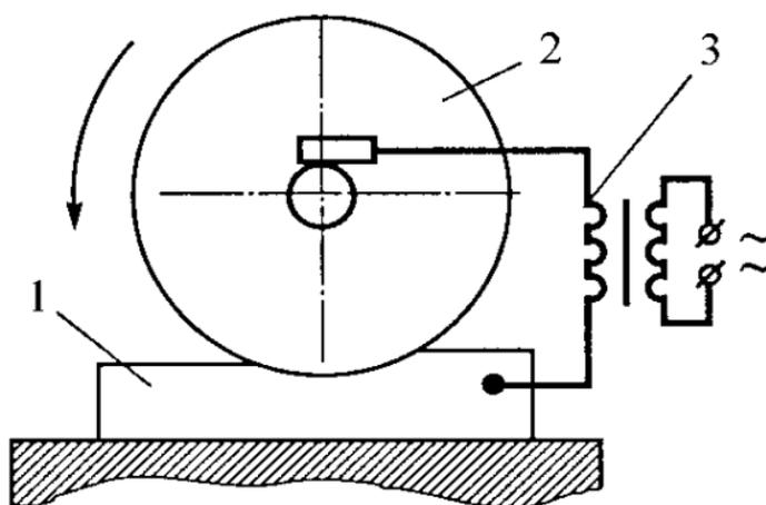
Рисунок 16 – Принципиальная схема электроконтактной обработки плоской поверхности периферией диска
