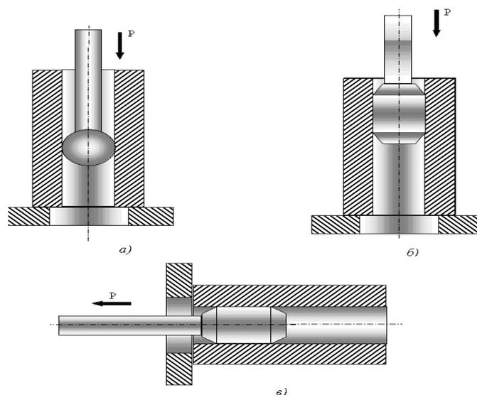
Рисунок 7 – Схемы калибровки отверстий
