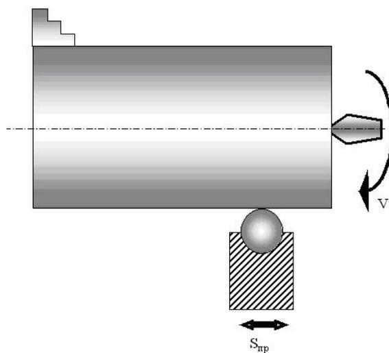
Рисунок 4 – Обкатывание одним шариком
