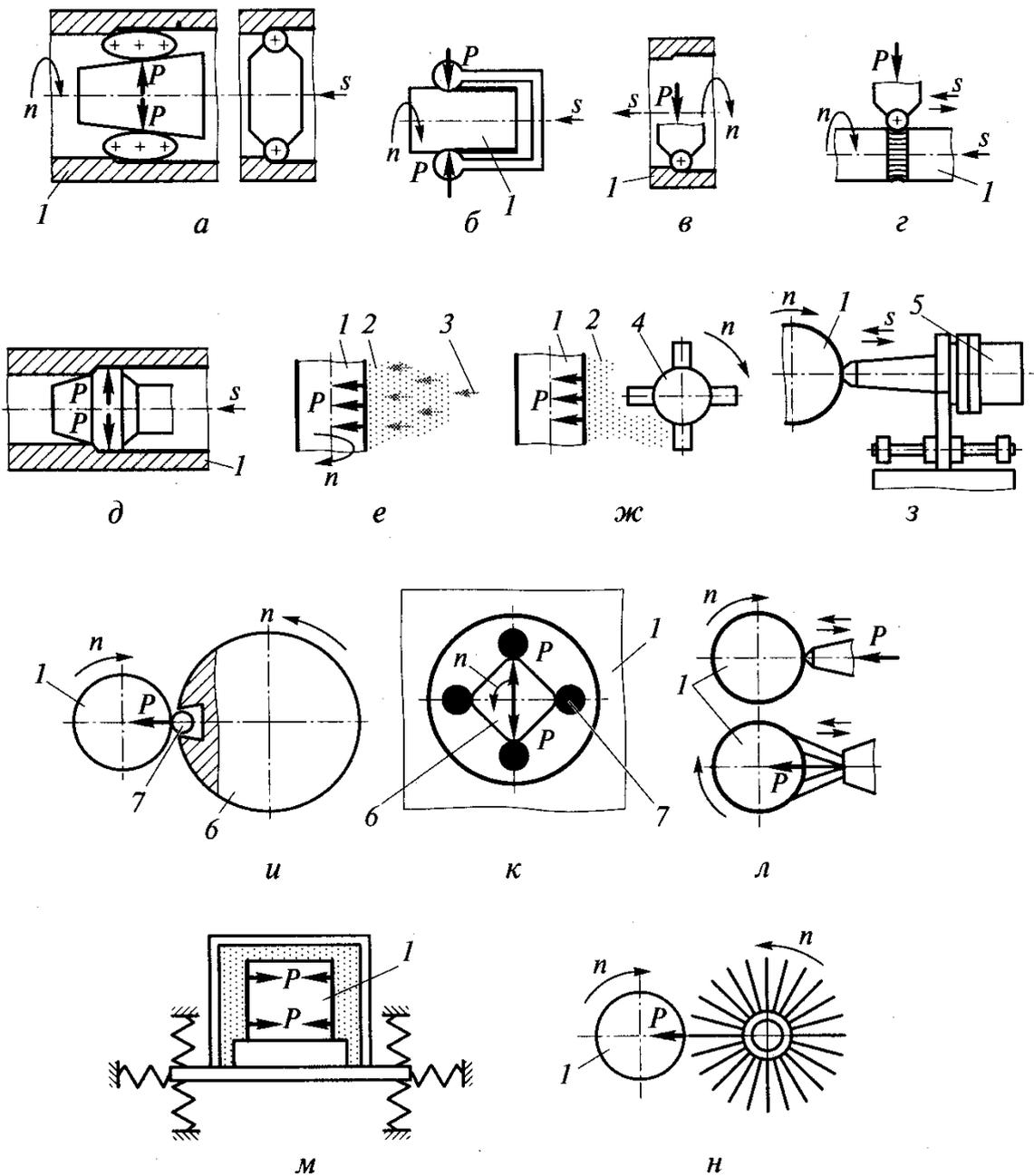
Рисунок 2 – Основные способы поверхностного пластического деформирования
