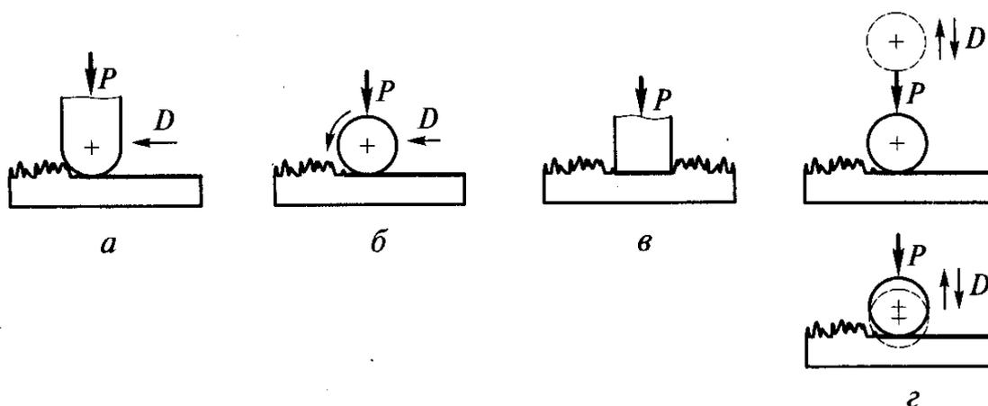
Рисунок 1 – Основные группы методов поверхностного пластического деформирования
