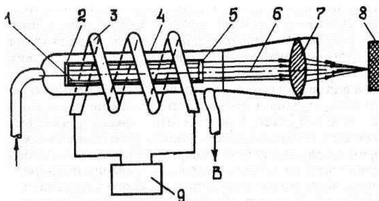
Рисунок 18 – Принципиальная схема оптического квантового генератора (рубинового лазера)
