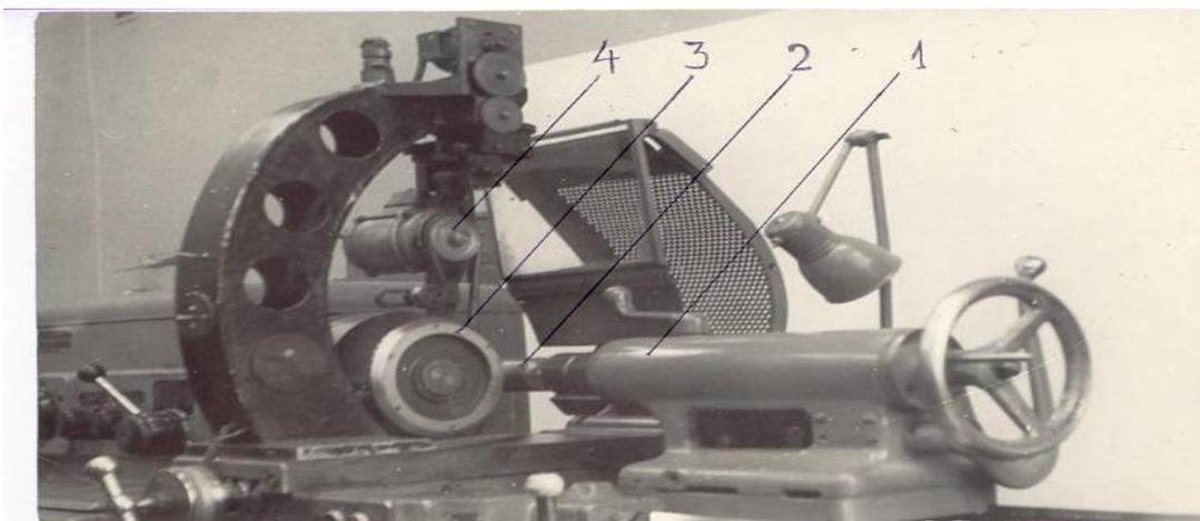
Рисунок 10 – Устройство для центробежной ударной обработки
