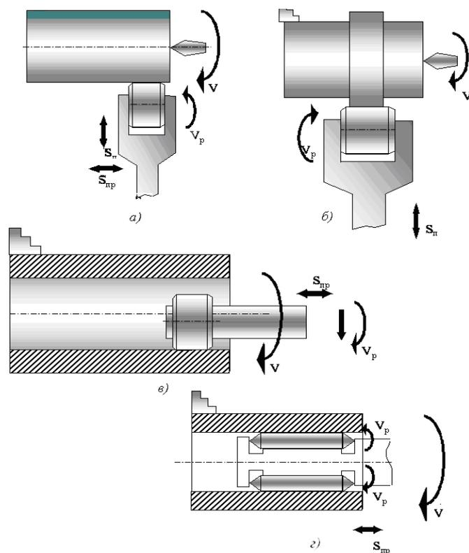
Рисунок 3 – Наружное обкатывание и раскатывание внутренней цилиндрической поверхности
