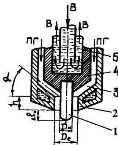
Рисунок 20 – Катодный узел плазмотрона
