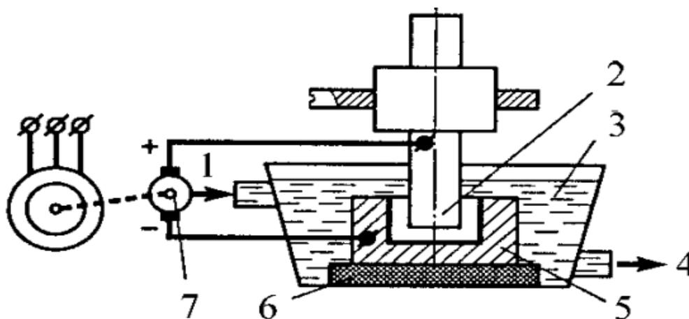
Рисунок 14 – Принципиальная схема электроимпульсной обработки
