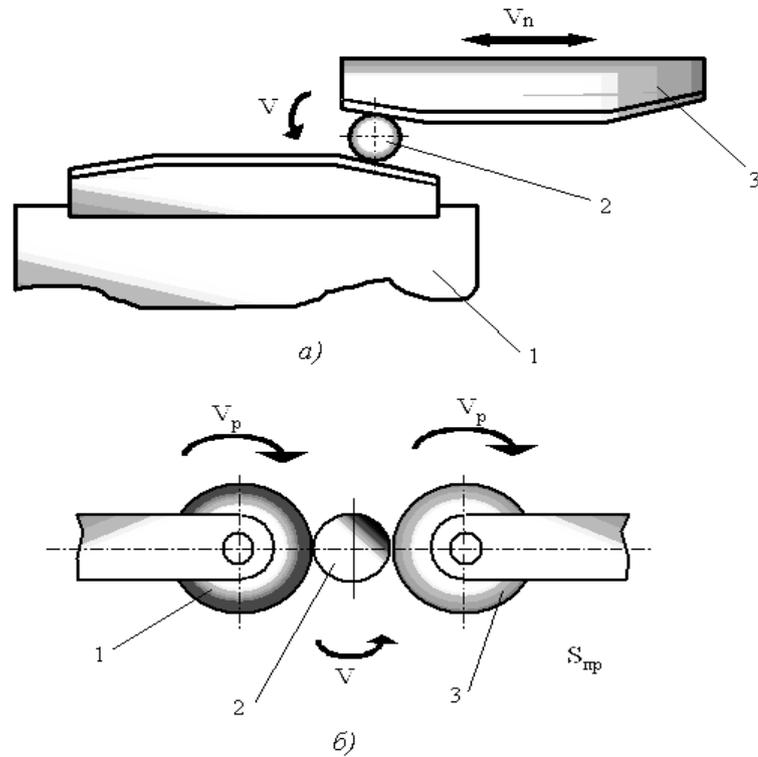
Рисунок 11 – Схемы накатывания резьбы
