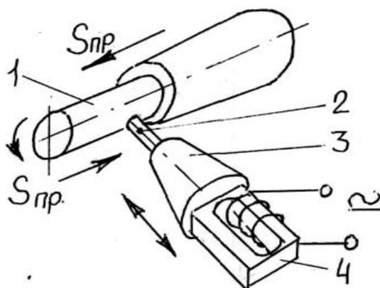
Рисунок 24 – Принципиальная схема комбинированной ультразвуковой обработки лезвийным инструментом
