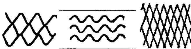
Рисунок 9 – Примеры микрорельефа, полученного вибронакатыванием или вибровыглаживанием
