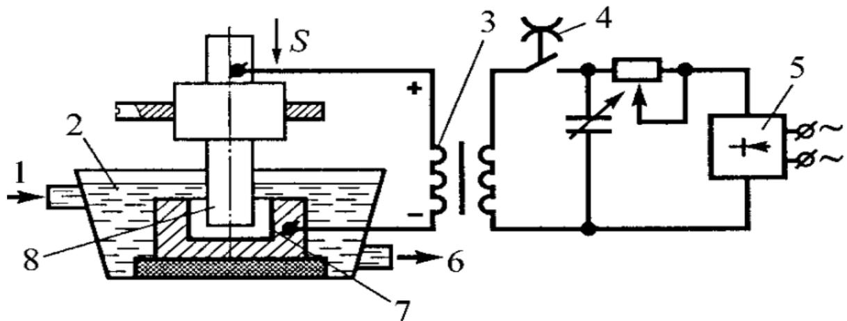
Рисунок 15 – Принципиальная схема высокочастотной электроимпульсной обработки
