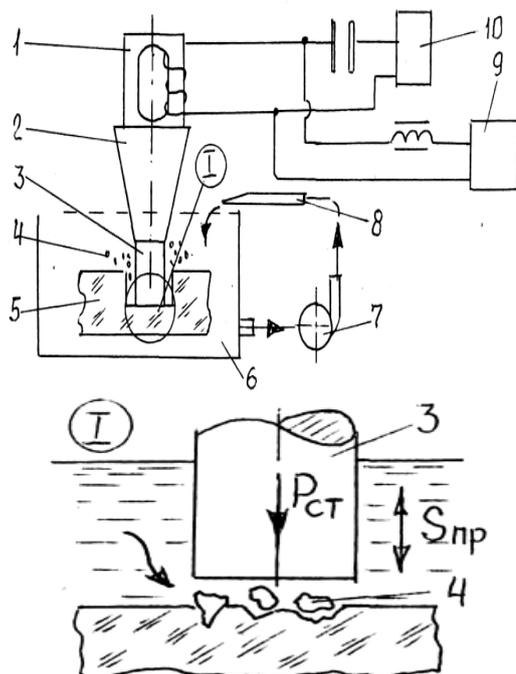
Рисунок 22 – Принципиальная схема прошивания отверстий
