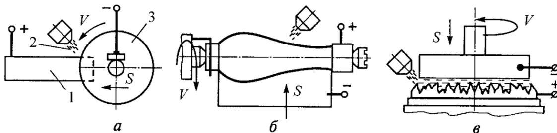
Рисунок 26 – Принципиальная схема анодно-механической обработки
