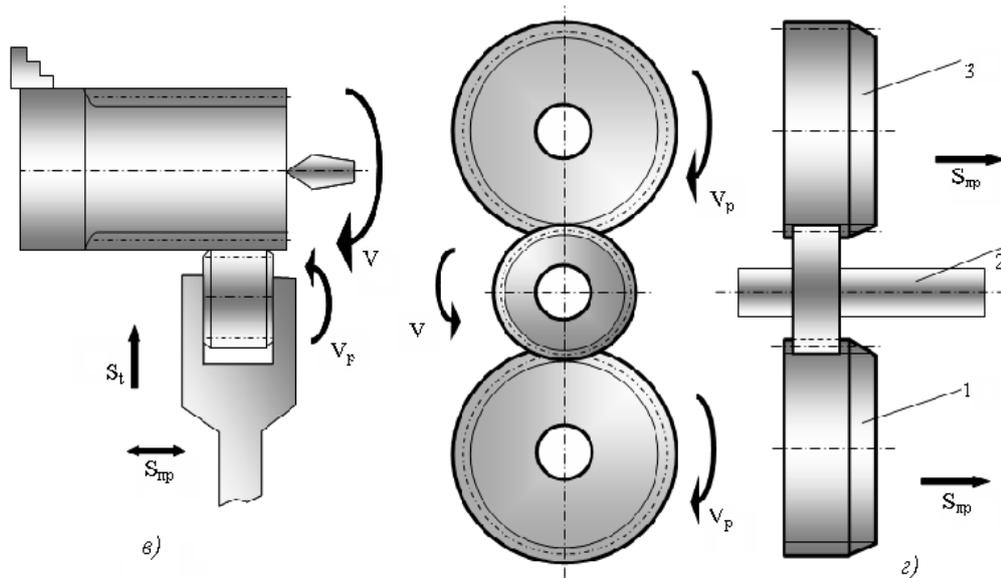
Рисунок 12 – Схемы накатывания рифлений, шлицевых и зубчатых профилей
