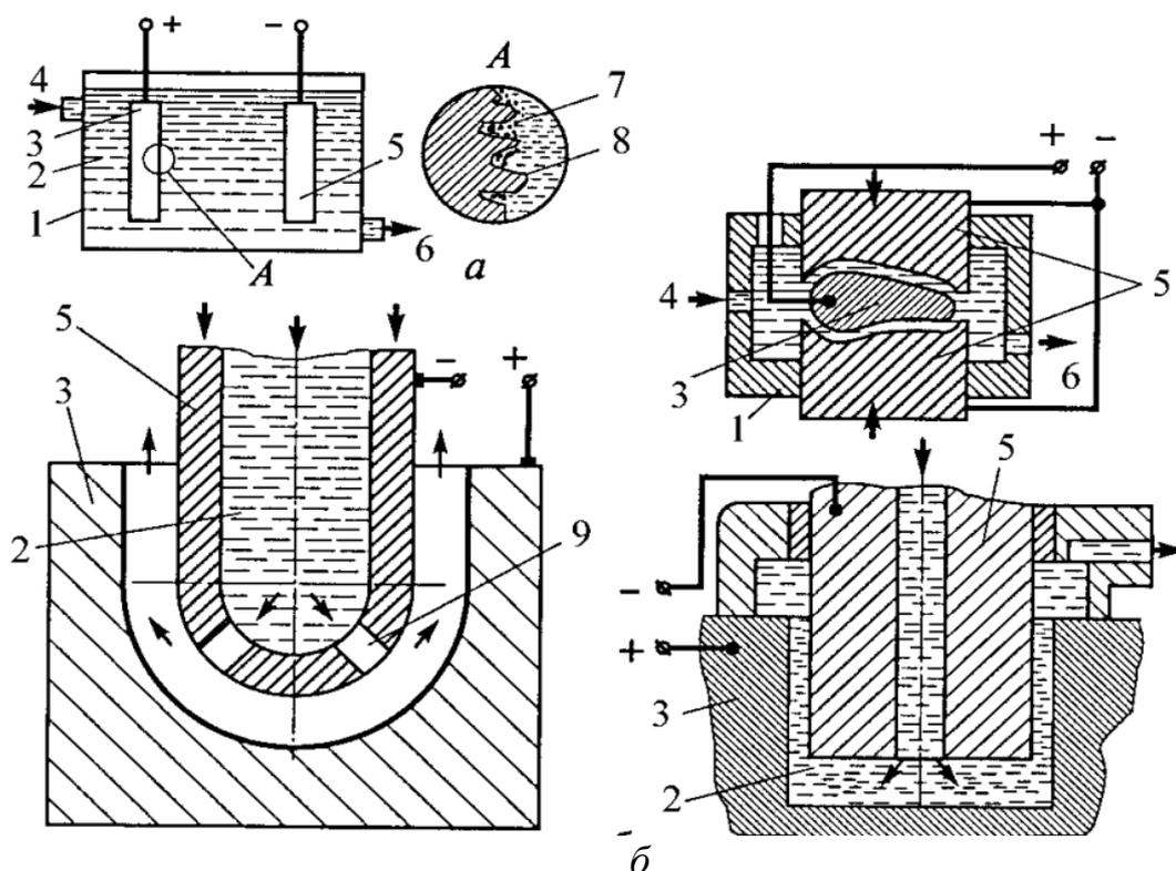
Рисунок 25 – Принципиальная схема электрохимической обработки
