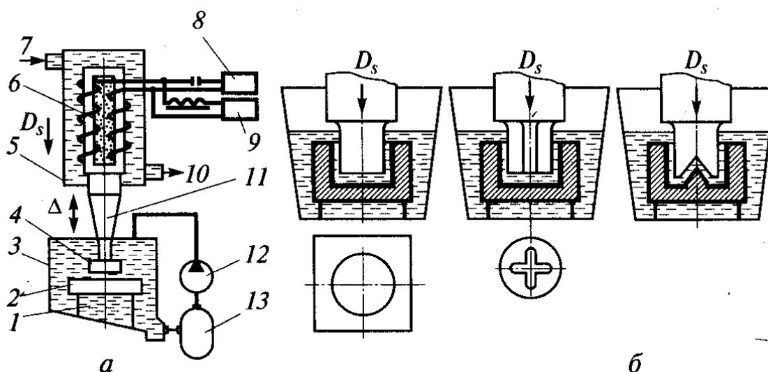
Рисунок 21 – Принципиальная схема ультразвуковой размерной обработки
