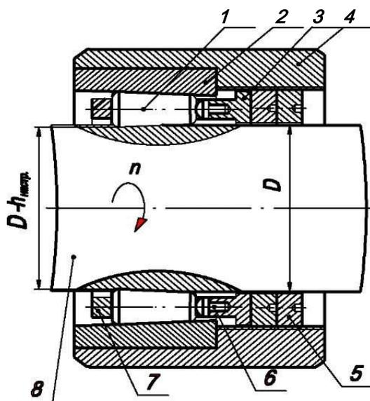
Рисунок 5 – Конструкция жесткого роликового накатника для обработки валов
