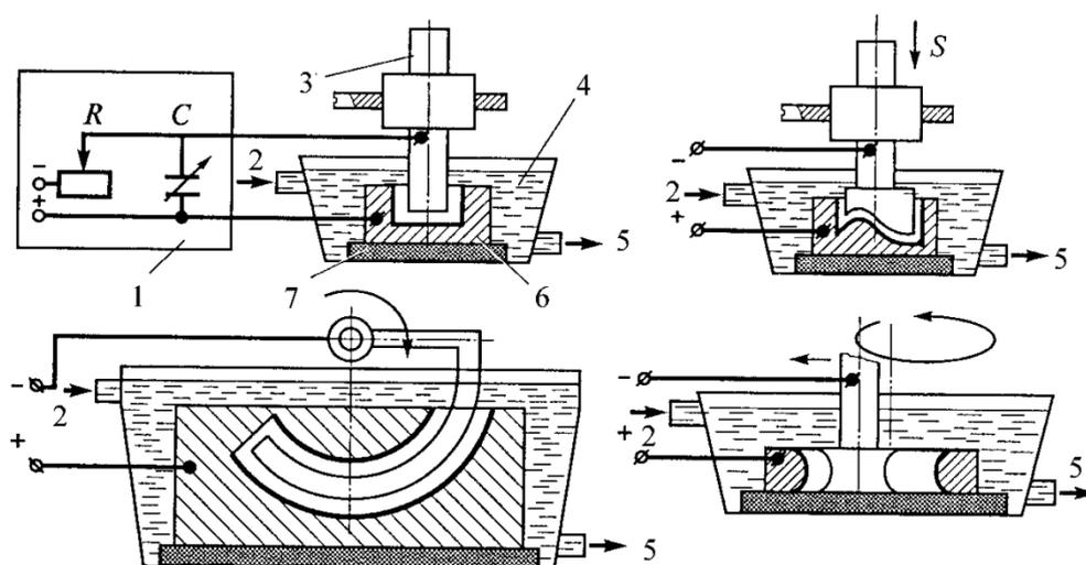
Рисунок 13 – Принципиальная схема электроискровой обработки
