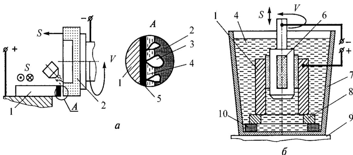
Рисунок 27 – Принципиальная схема электроабразивной обработки
